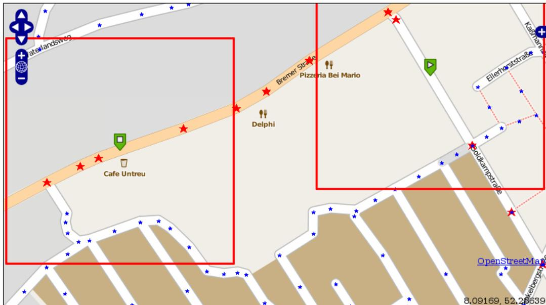
**Abbildung 20:** Ermittlung der nächstgelegenen Kanten zu den vom User gesetzten Markern innerhalb einer BoundingBox von 200m
